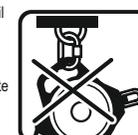
udstyret bør ikke fastgøres til punktet på den permanente konstruktion (forankringspunktet) vha. et beslag
