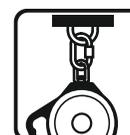
fastgør udstyret til punktet på den permanente konstruktion (forankringspunktet) vha. et drejeregreb
